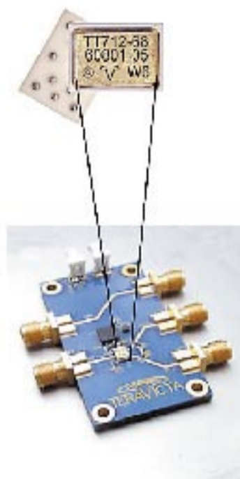
TeraVICTAs MEMS-baserade 7 GHz SPDT-switch TT712 är 3,25x4,50x1,25 mm stor. Switchtiden ligger under 100 µs och Inlänkingsdämpningen är mindre än 0,1 dB vid 1 GHz.
